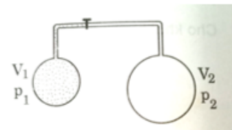
Hình. Một bình chứa khí thông với một bình hút chân không
